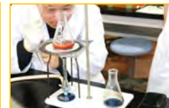
▲液体・泡の色の变化で乳糖を測定
